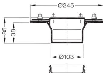
**Aufsatzelement mit Muffe**
